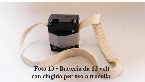
Foto 13 • Batteria da 12 volt con cinghia per uso a tracolla
