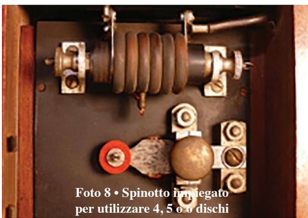
Foto 8 • Spinotto impiegato per utilizzare 4, 5 o 6 dischi
