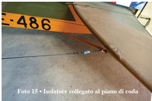
**Foto 15 • Isolatore collegato al piano di coda**
