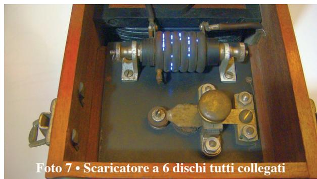
Foto 7 • Scaricatore a 6 dischi tutti collegati
