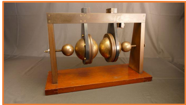
Photo N° 4 type Righi 4 balls oscillator
