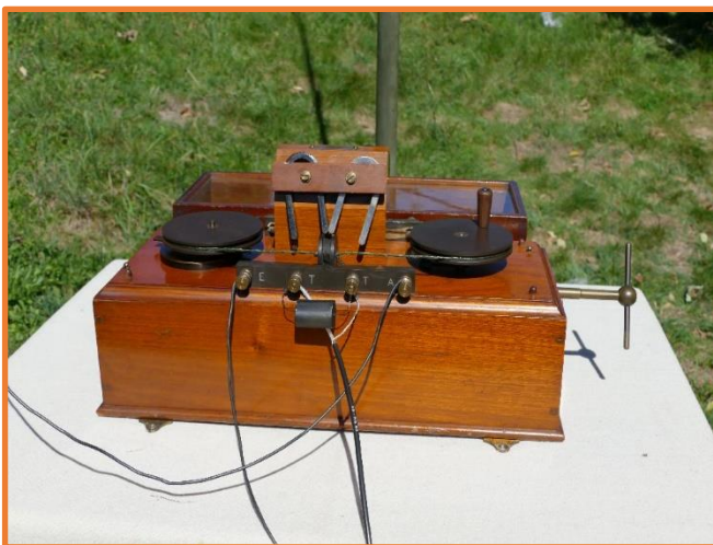
Fotografia N° 9 Il detector magnetico in funzione
