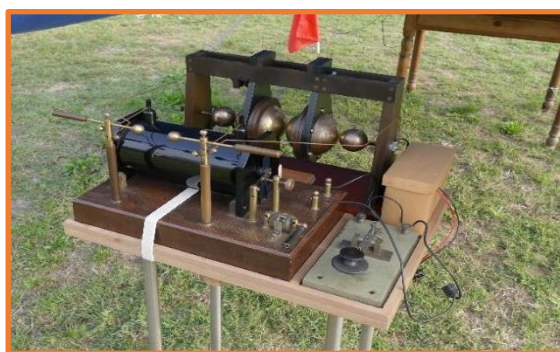
Fotografia N° 6 componenti del trasmettitore fissati su un piano di legno
