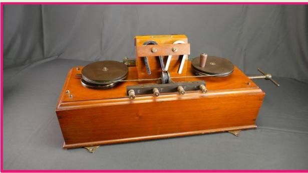
**Photo N° 7 Marconi Magnetic Detector**
