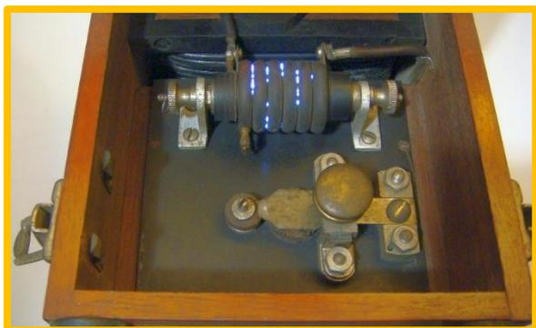
**Foto N° 7 scaricatore a 6 dischi tutti collegati**
