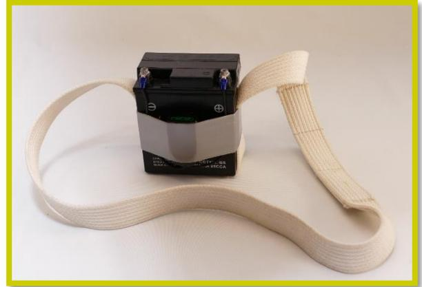
Foto N° 13 batteria da 12 Volt con cinghia per uso a tracolla telegrafico fissato con elastico
