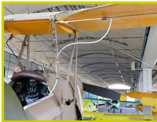
Foto N° 16 isolatore elettrico e tubo isolante fascettato al montante interalare per fare entrare nell'abitacolo il cavo d'antenna
